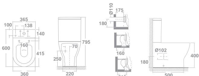
**Nota:** \*El conjunto inodoro completo está formado por: inodoro para tanque bajo BTW rimless, tanque completo de 4/2 litros y asiento fijo. BTW: Pegado a la pared. \*\* El conjunto inodoro completo está formado por inodoro para tanque bajo BTW, tanque completo de 4,5/3litros y asiento fijo.
