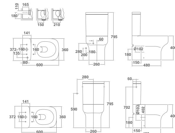
**Nota:** \*El conjunto inodoro completo está formado por: inodoro para tanque bajo BTW rimless, tanque completo de 4/2 litros y asiento fijo. BTW: Pegado a la pared. \*\*El conjunto inodoro completo está formado por: inodoro para tanque bajo BTW, tanque completo 4,5/3L y asiento fijo.
