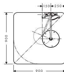
Las tomas de agua existentes no siempre se encuentran en el centro de la ducha. Gracias al brazo de ducha giratorio, el cabezal puede orientarse hacia el centro de la ducha una vez finalizada la instalación.
